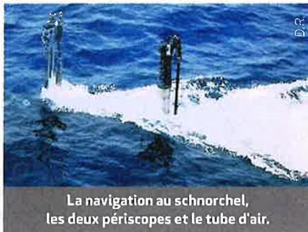
La navigation au schnorchel, les deux périscopes et le tube d'air.
