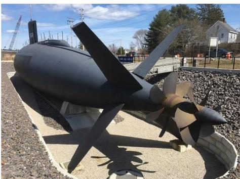
*Sous- marin Albacore dans sa dernière configuration (empennage en X et hélices contrarotatives)*
