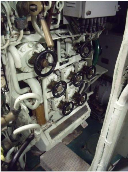
*L'aquarium. Le tuyautage le plus important à droite est celui de la purge de la coupole. Les autres tuyautages sont des purges de mâts.*
