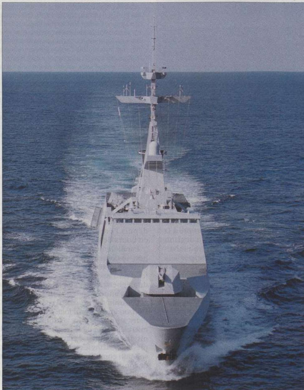
La réduction de la surface équivalente radar s'obtient essentiellement grâce à l'inclinaison des bordés et des superstructures. (Photo Marine nationale/CPGP)
